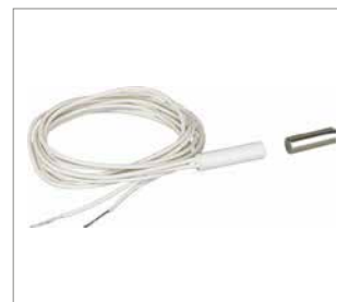
Reedkontakt Einfacher Reedkontakt oben in Stock und Türblattfalz eingebohrt Rückmeldung: Tür liegt im Falz
